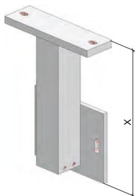
Idéal pour montage dans des avant-toits ou en cas de toits-terrasses et convient pour être collé dans le revêtement de toit. Avec trous oblongs pour le montage de la console elle-même et du profilé du garde-corps.
