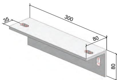
À utiliser avec des profilés de montage supérieur et latéral. Les profilés peuvent être montés sur, contre ou dans la ligne d'angle. Avec trous oblongs pour le montage de la console elle-même et du profilé du garde-corps.
